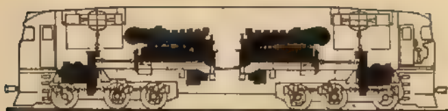
Schema transmisiei hidraulice la locomotiva Diesel cu două secții
